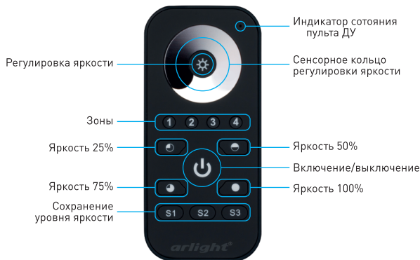
Рис. 2. Назначение элементов управления пульта.
