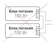
Защита от перегрузки, в зависимости от конкретного технического решения, для ряда блоков питания может работать некорректно. Поэтому такое включение не рекомендуется.
